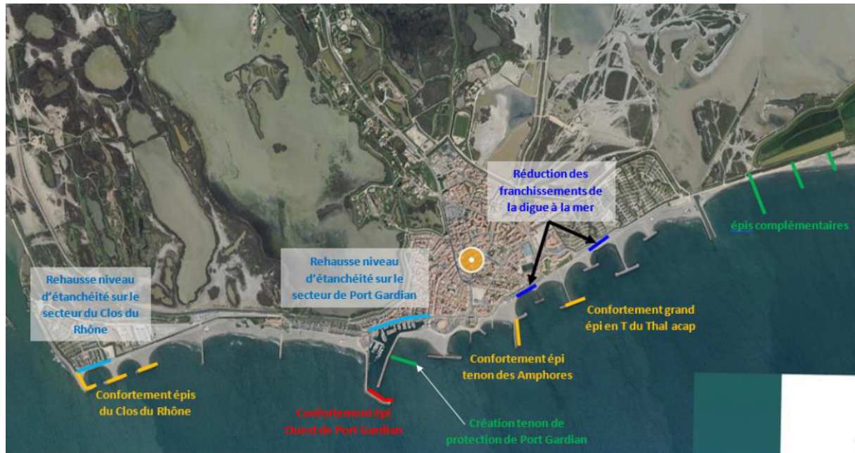
Carte n° 16 : Travaux prévus de renforcement des ouvrages de défense contre la mer au droit des Saintes-Maries-de-la-Mer
